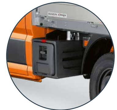
Werkzeugkasten Unter der Ladefläche angebracht.
