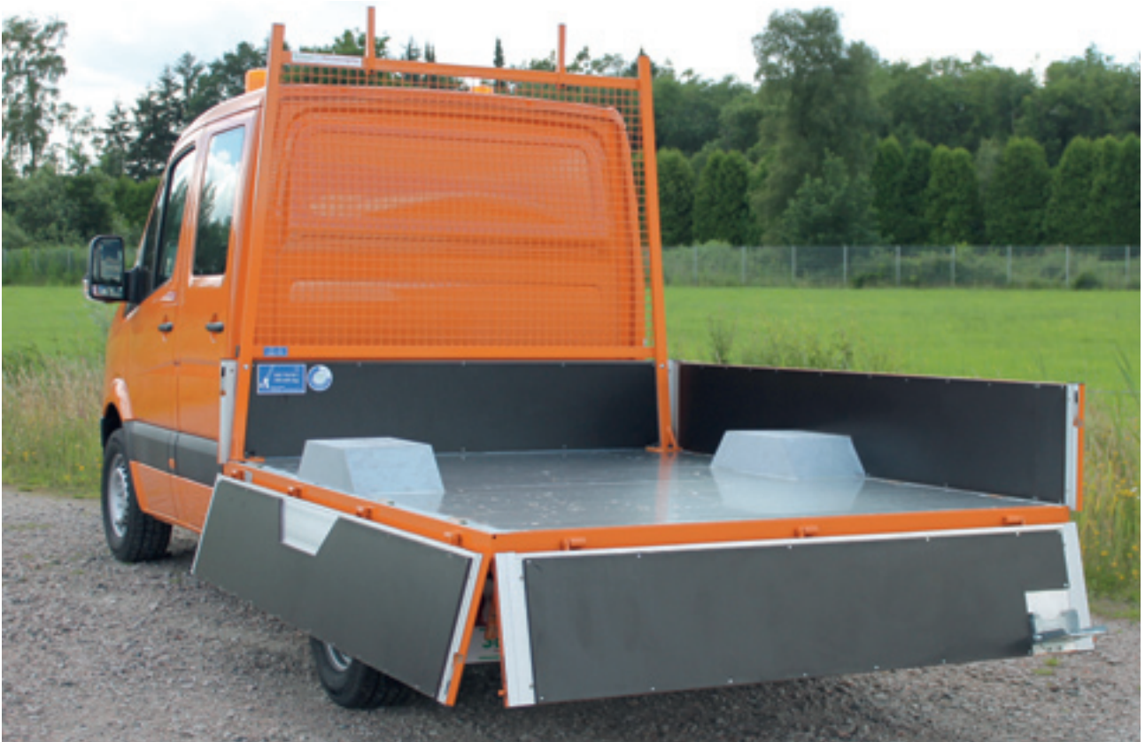
Bordwände innen mit Holzverkleidung, Stirnwandgitter, Rahmen und Bordwände außen in Kommunal-Orange lackiert
