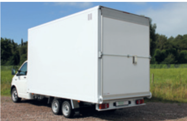
Volkswagen Transporter mit Schoon Koffer, AL-KO Fahrgestell, Rampe
