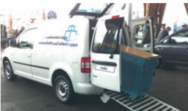
Hoher Ladekomfort dank Heckausschnitt und Leiterklappe
