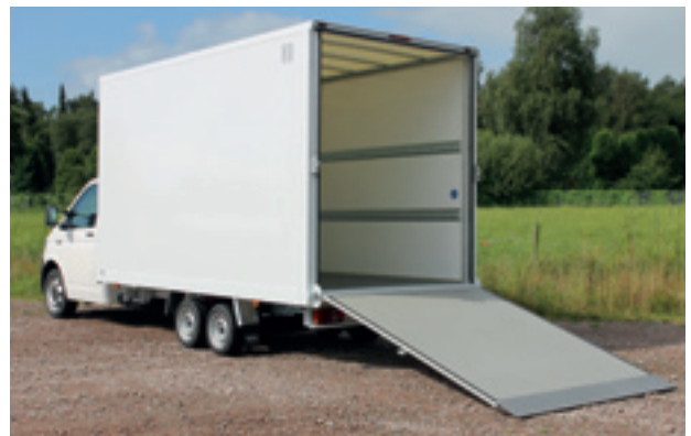
Volkswagen Transporter mit Schoon Koffer, AL-KO Fahrgestell, Rampe
