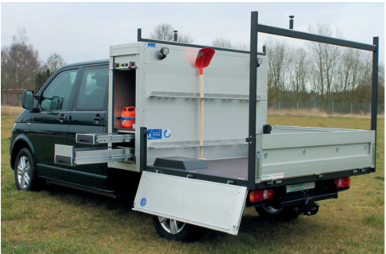
Allrad, Seilwinde, Werkzeug- und Gerätekasten, Schaufel- und Besenhalter (2-teilig in Edelstahl), Heckauflagegestell, Anhängerkupplung, Arbeitsscheinwerfer, Netzhaken
