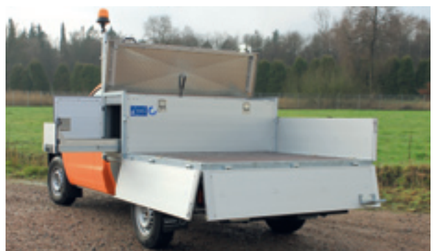
Schoon Pritsche mit integrierter Werkzeugkiste
