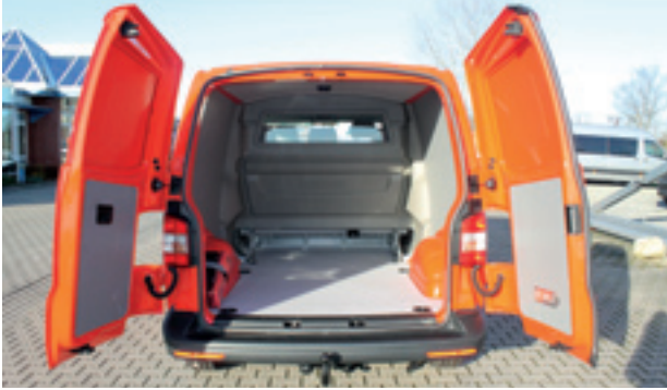
Kastenwagen mit Kunststofftrennwand
