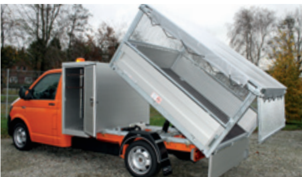
Schoon Drei-Seiten-Kipper mit Laubgitteraufsatz
