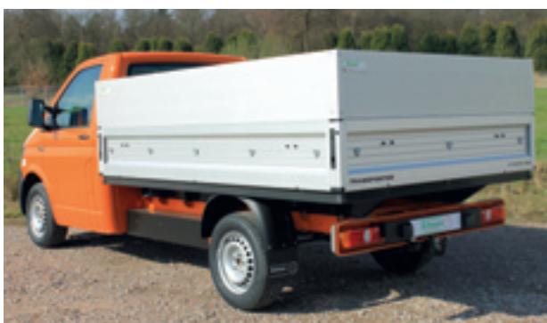
Werkspritsche mit Schoon Bordwandaufsätzen
